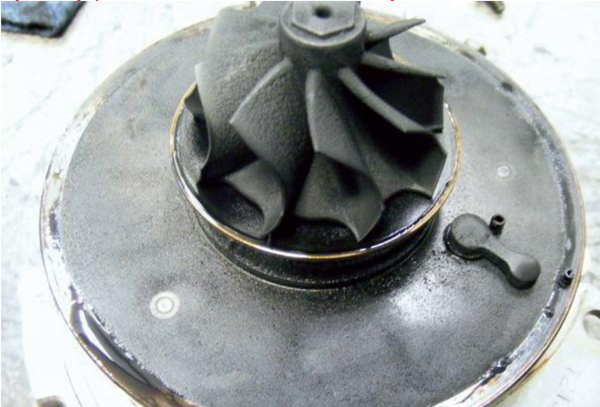
Oljelekkasje på turbinsiden forårsaket av tett returoljerør.
