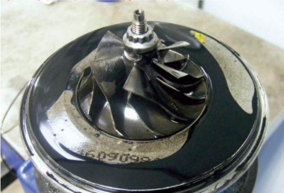
Oljelekkasje på kompressorside. pga undertrykk.
