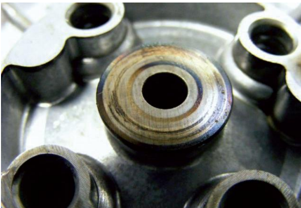
Skadet og missfarget overflate pga oljemangel.
